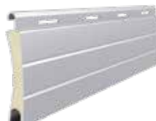
PA 40 pas de lame : 40 mm hauteur : 8,7 mm
