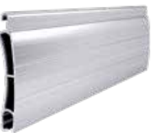
PE 41 | profilmagassága: 41 mm vastagság: 8, 5 mm
