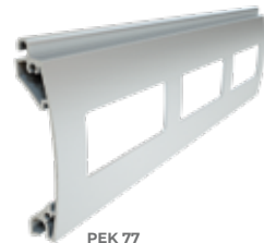
PEK 77 profielhoogte: 77 mm dikte: 18,5 mm
